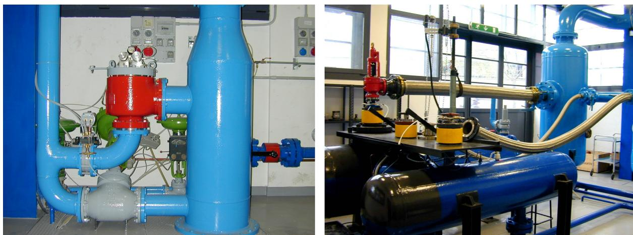
Figura 2 : Serbatoi di controcompressione e di prova con valvola installata e raccordi universali per il convogliamento dello scarico al serbatoio di controcompressione
